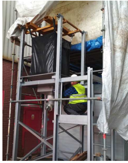
Rysunek5 Worek Big Bag podwieszony na stacji Big Bag
